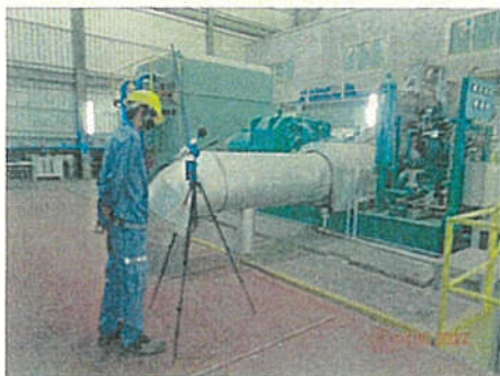
รูปแสดงการตรวจวัดระดับเสียงเพื่อจัดทำแผนผังระดับเสียง (Noise Contour Map)
